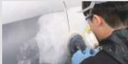
5. 표면 IR건조 후 샌딩 작업 : 샌딩 후 표시된 부분과 같이 철판이 노출된 경우 방청을 위해 에폭시 프라이머를 도포해줌
