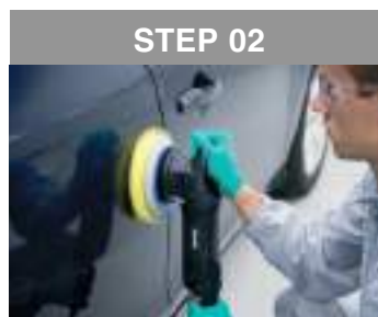
STEP 02 손상 부위에서 가장 가깝고 평평한 부위를 선택하여 표면을 깨끗하게 세척 및 폴리싱 작업
