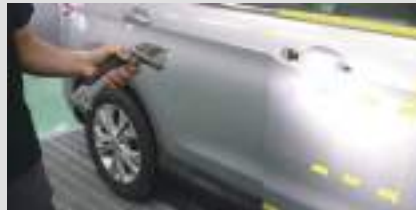
2. 시편 작업 후 컬러 확인(빛반사유사각도, 정면, 그늘진 측면)
